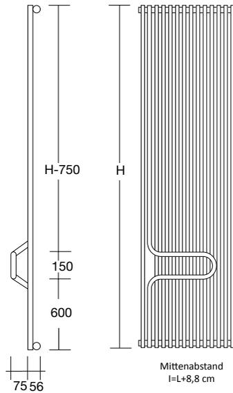
**ANSCHLÜSSE** Die Handtuchwärmer werden serienmäßig mit Anschlüssen „OC1“ geliefert
