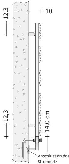
Anschluss an das Stromnetz mit Standard-Verschlusskappe
