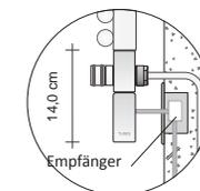
Kabellose Verbindung mit DESIGN-Verschlusskappe farbig lackiert (geliefert mit Preisaufschlag)
