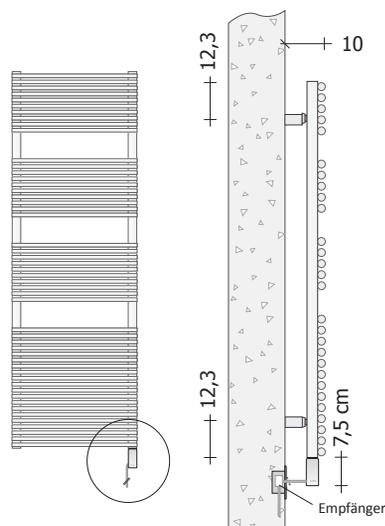
Kabellose Verbindung mit Standard-Verschlusskappe
