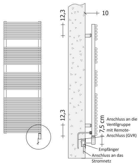
Kabellose Verbindung mit Standard-Verschlusskappe
