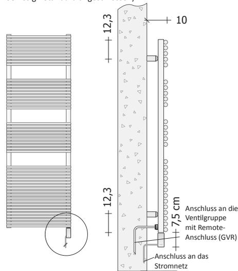
Anschluss an das Stromnetz mit Standard-Verschlusskappe
