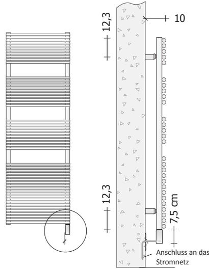
Anschluss an das Stromnetz mit Standard-Verschlusskappe
