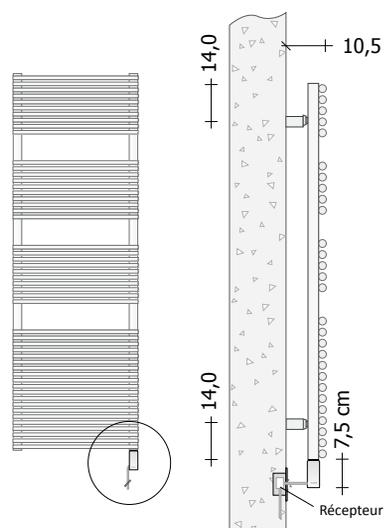
Raccordement sans fil avec Terminaison Standard
