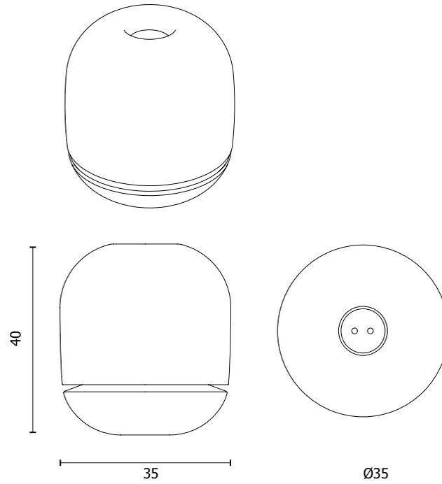
MATERIALE: POLIURETANO RIGIDO STRUTTURALE AD ALTA RESISTENZA MECCANICA.
