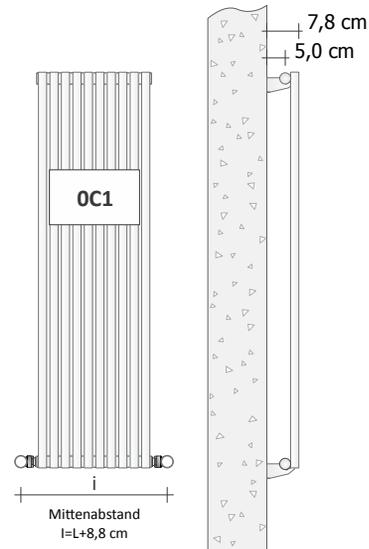
**ANSCHLÜSSE** Die Handtuchwärmer werden serienmäßig mit Anschlüssen „OC1“ geliefert
